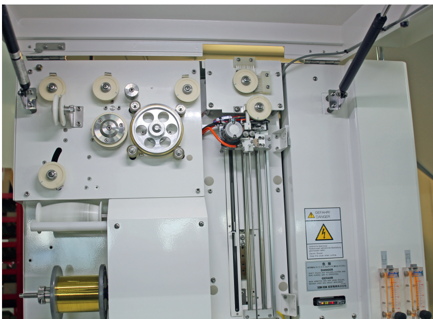
98 % Erfolgsquote beim Einfädeln: Unter der Haube der M25LP sieht man in der Bildmitte den komplexen Mechanismus für das automatische Einfädeln des Drahts.
