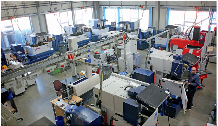
Hohe Präzision erfordert gute Temperierung: Die Maschinenhalle mit zahlreichen Seibu-Drahterodiermaschinen ist deshalb voll klimatisiert. (© Klaus Vollrath)
